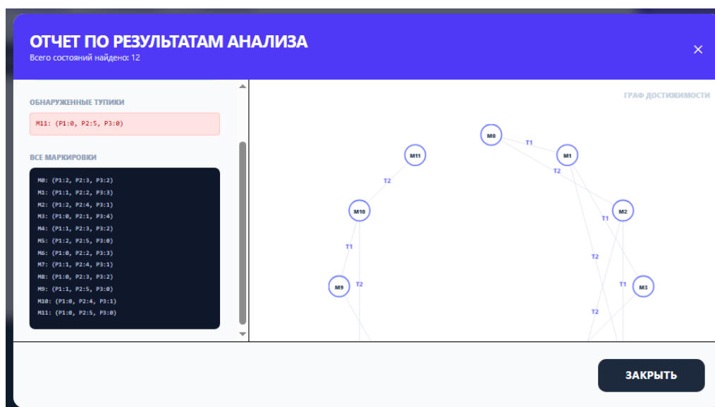
Рис. 2. Фрагмент графа достижимости с выделенными тупиковыми состояниями
